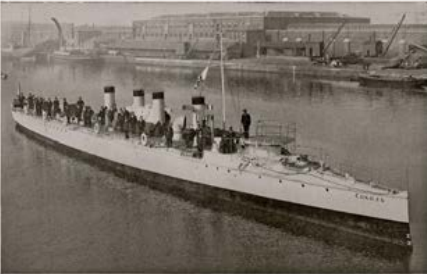
Yarrow-telakan Venäjän laivastolle rakentama torpedohävittäjä oli ensimmäinen avomeriolosuhteissa 30 solmun nopeuden ylittänyt alus. Kuvassa koeajot ovat päättäneet ja vielä aseistamaton Sokol on lähdössä Venäjälle.
